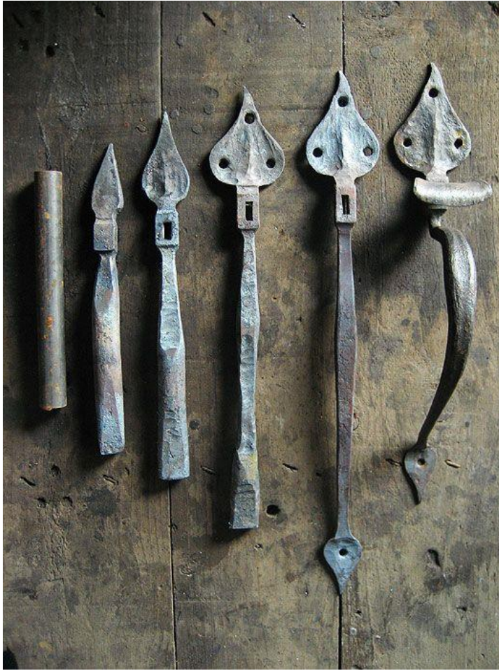
Елемент замка. Залізо, ковальство, поетапність виконання.
